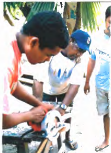
Implementación de la sierra radial para realizar cortes rectos a madera gruesa
