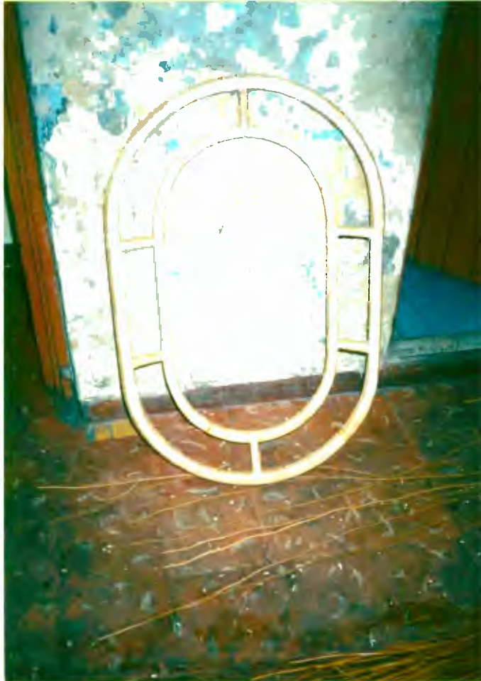
Estructura marco espejo. Embarrilado mimbre común.
