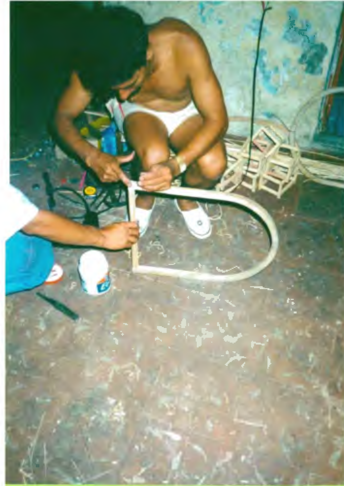
Armado, colbonado estructura 3aul.
