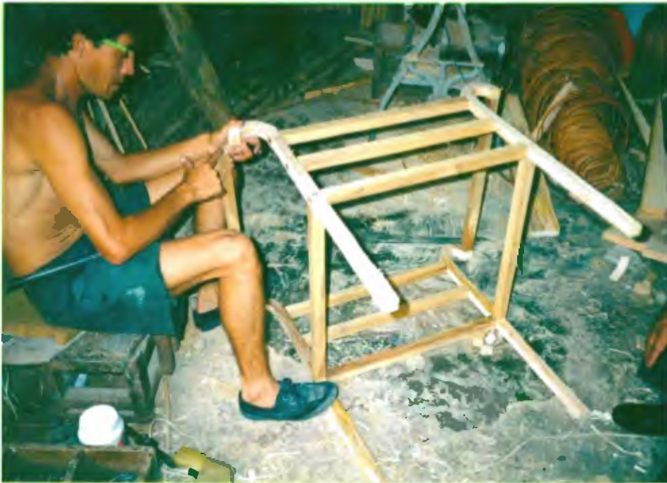
Colbonado estructura base comedor.
