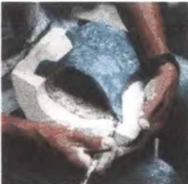
9. Se espera que la primera pieza del molde fragüe, para invertir la formaleta, retirar la arcilla que cubría la otra sección, y limpiar de residuos de arcilla las superficies
