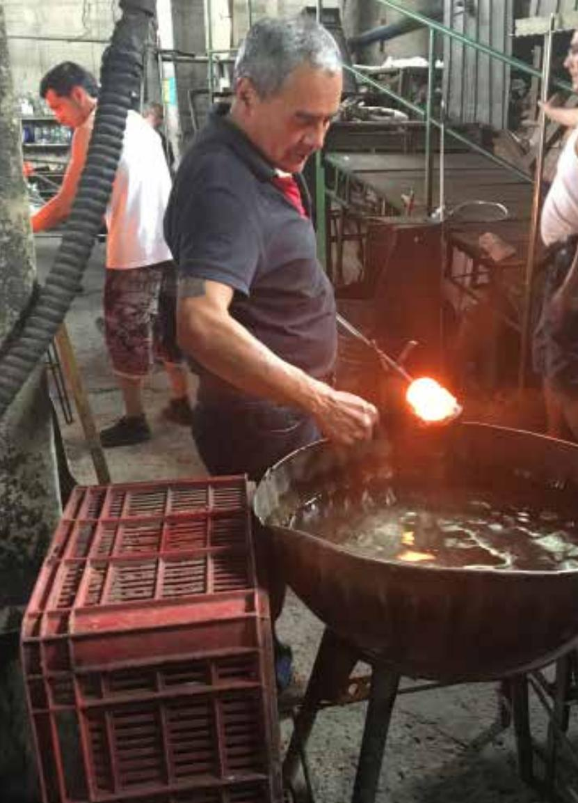
donde entra en reposo la pieza después del proceso de elaboración de la pieza para que no se quiebre o se produzcan rupturas debido al cambio de temperatura o al choque térmico.
