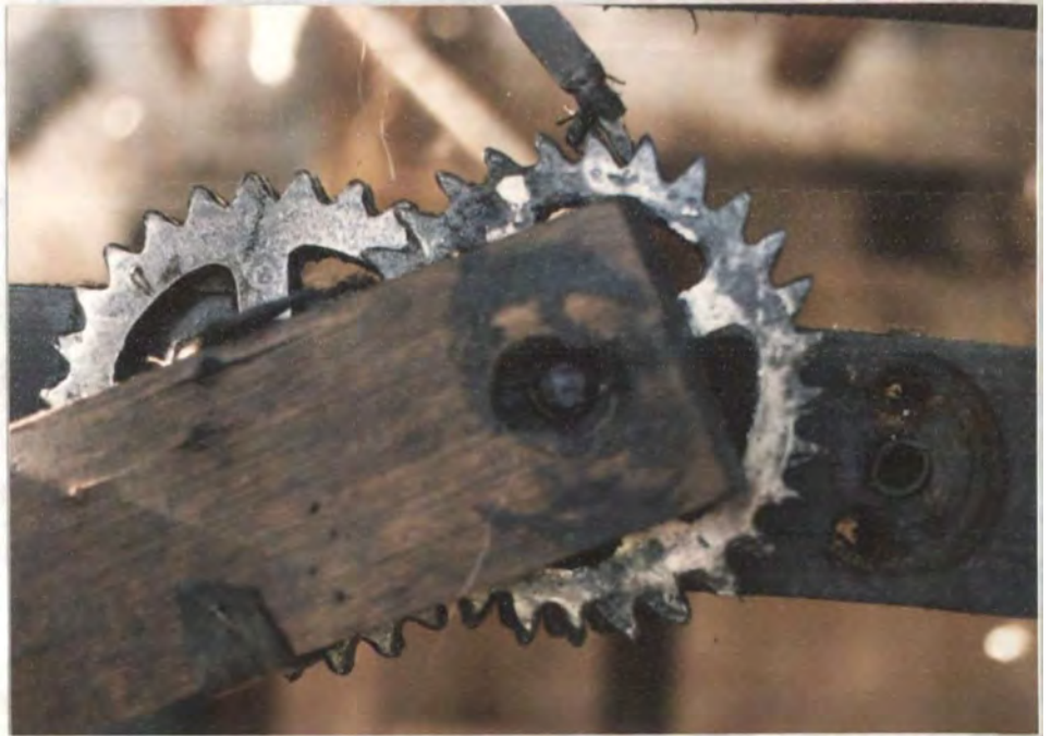
Fotografía #16: Detalle de los piñones que componen el sistema de engranaje. Parte del telar manual. Guarne, Ant..
