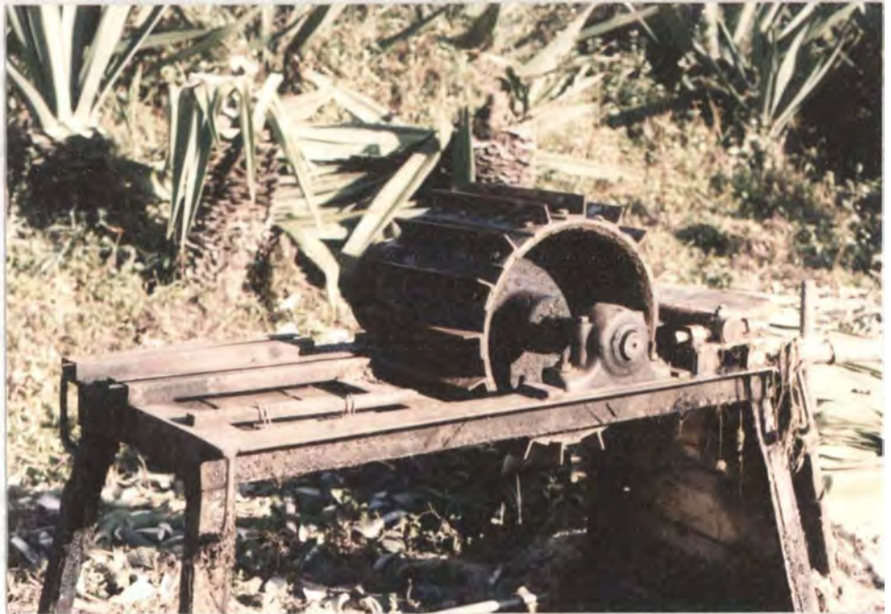
Fotografía #13: máquina desfibradora desprovista del motor durante un descanso de fin de semana. Se destaca el cilindro con las cuchillas raspadoras. Vereda Bellavista. Guarne, Ant..
