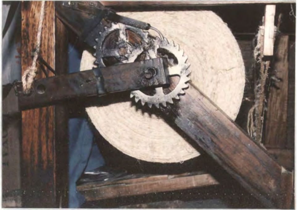
Fotografía #15: Una vez tejida la tela se enrolla por medio de un sistema de engranaje. La introducción de éste es la innovación más reciente en el telar manual de Guarne. Ant..
