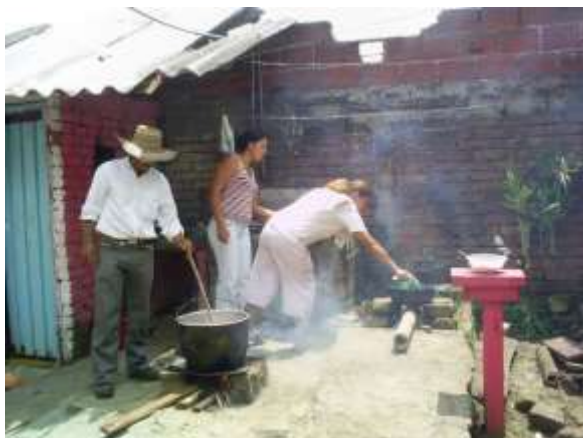
Artesanos realizando el proceso de tintura de la fibra de plátano en hornos de leña con tintes industriales.
