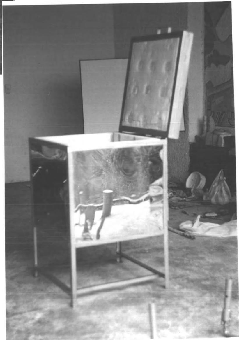
Horno refractario a gas. totalmente terminado y probado.
