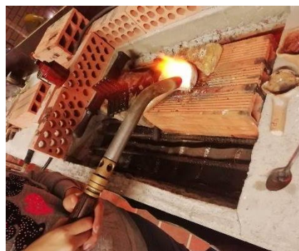
Mejoramiento Curado de crisol para fundición Tomada por: Katherine Cano California Santander, octubre /2019 Artesanías de Colombia S. A.
