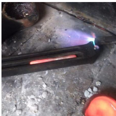
Fundición en lingotera Tomada por: Katherine Cano California - Santander: noviembre /2019 Artesanías de Colombia S. A.
