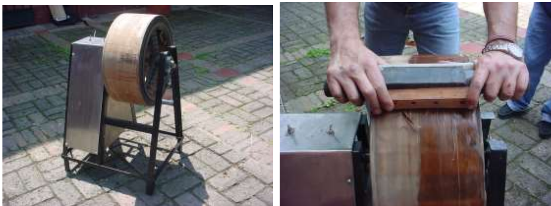
Unidad de diseño 2006 – tambor giratoria para calceta de platano – D.I Manuel Abella
