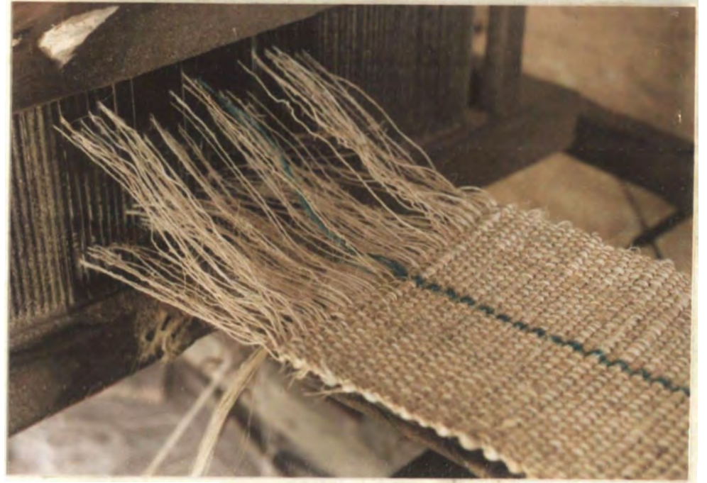
Fotografía 47. Tejido de la tapa de enjal- ma igual al de la riata pero con mas hilos de urdimbre. Vereda Chaparral.
