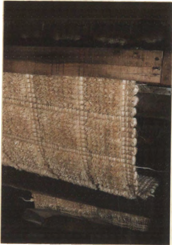
Fotografía 42. Tapiz en el telar con mez- cla de texturas entre mecha y tafetán. Guarne.
