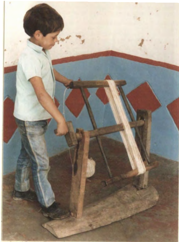
Fotografía 7. El envolvedor se hace girar con la mano para ir formando la madeja. Vereda Chaparral.
