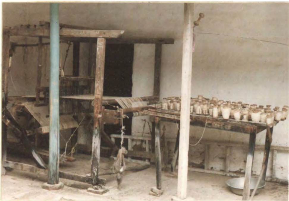
Fotografía 12. Telar manual de 2 marcas con mesa horizontal. Taller en Guarne.
