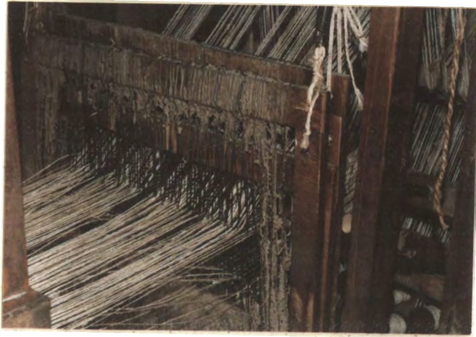
Fotografía 40. Telar de 3 marcos para el tejido de los tapices Guarne
