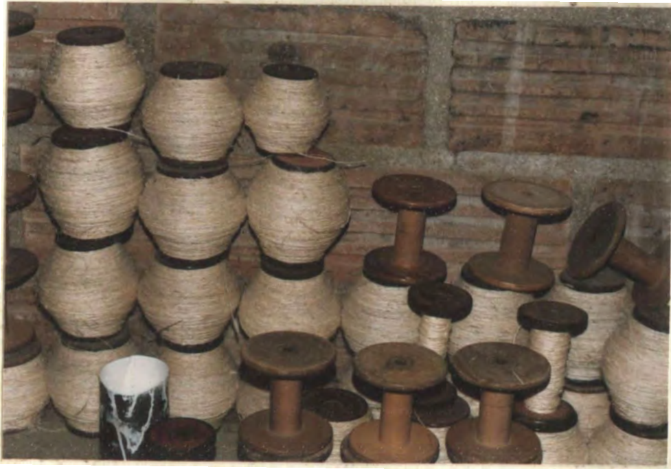
Fotografía 24. Carretes surtidos con el hilo de urdimbre para co- locarlos en la mesa. Guarne.
