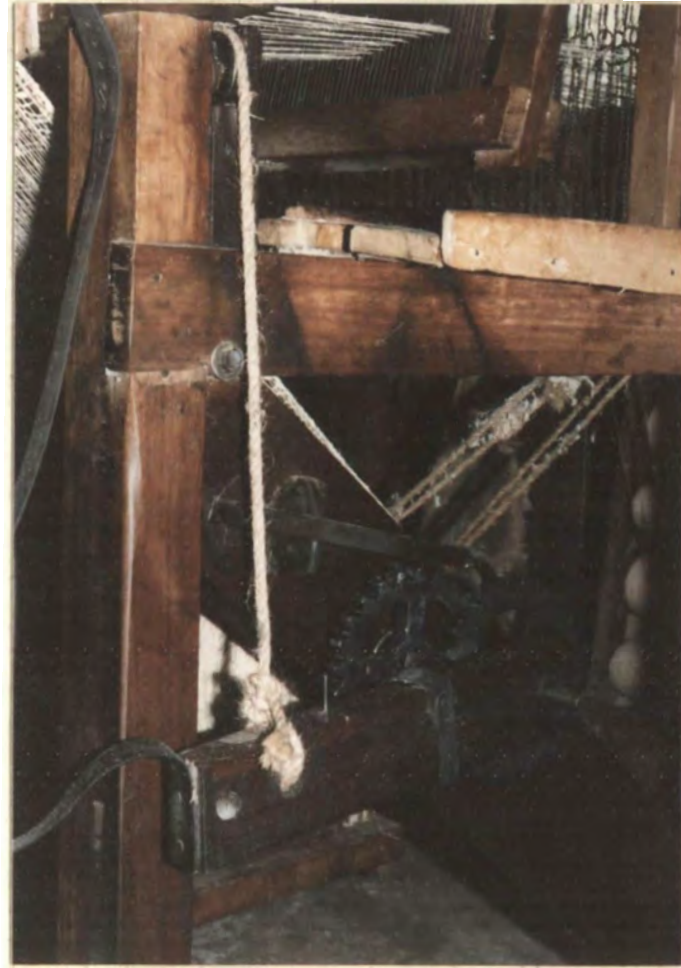
Fotografía 37. Al peinar giran los pinones que van envuolviendo la tela en el rodillo Guarne.
