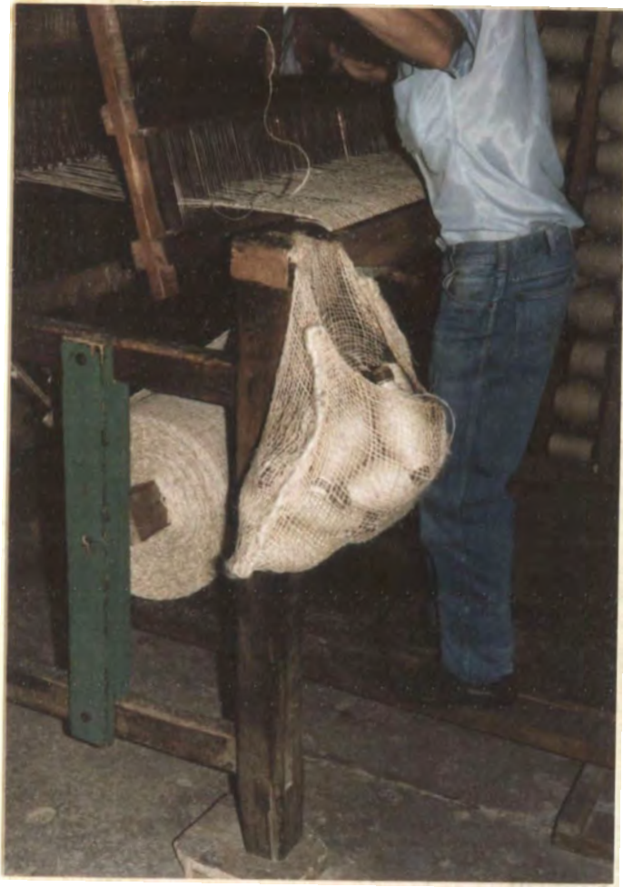
Fotografía 31. Acción de los pedales con los pies para formar la calada. Guarne.
