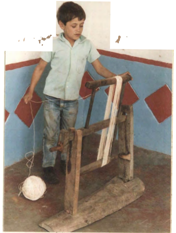
Fotografía 8. La cabuya se debe tener en un ovillo grande y de allí va pasando al envolvedor. Vereda Chaparral.
