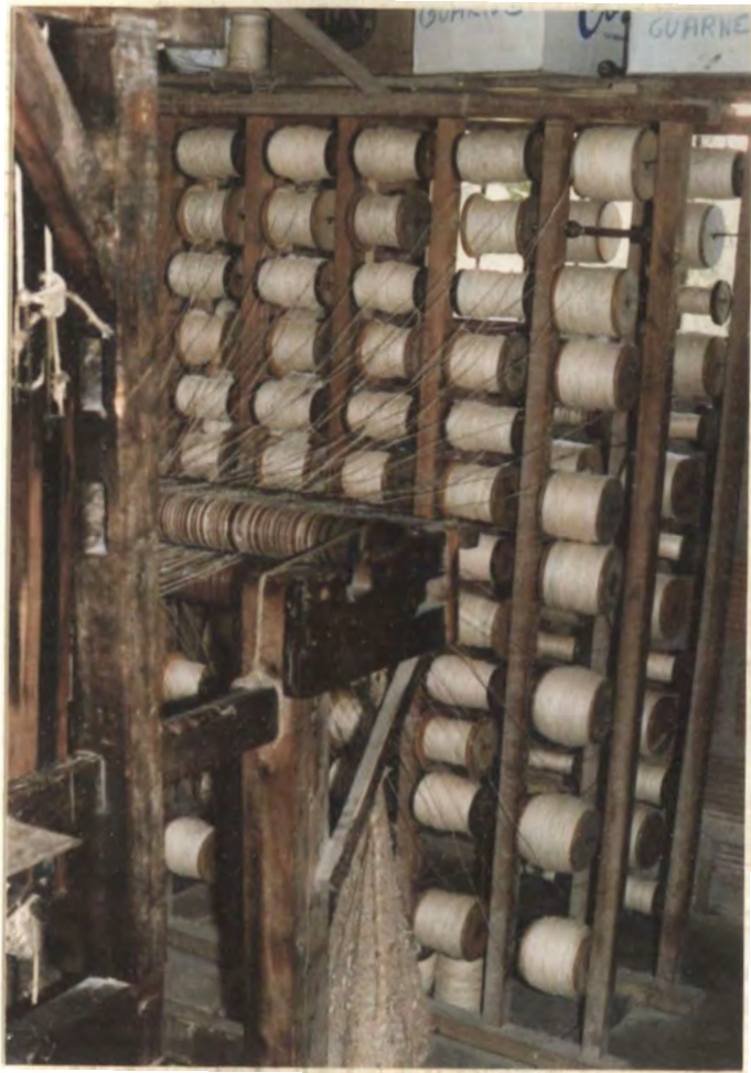
Fotografía 14. Mesa vertical portadora de los carretes con el hilo de la urdimbre Guarne
