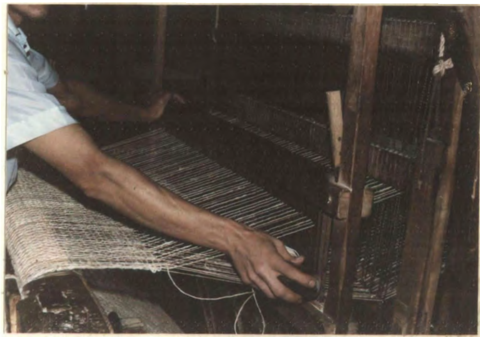
Fotografía 35. La pasada de la lanzadera se hace de izquierda a de- recha y de derecha a izquierda. Guame.
