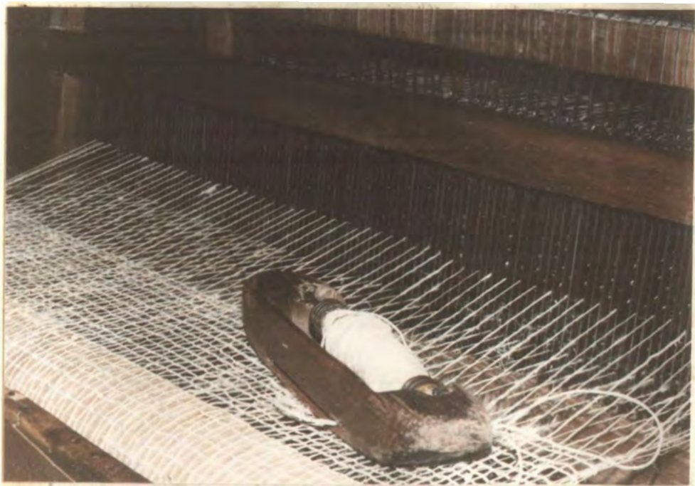
Fotografía 17. Lanzadera con carrete pa- ra la trama de la tela. Guarne.
