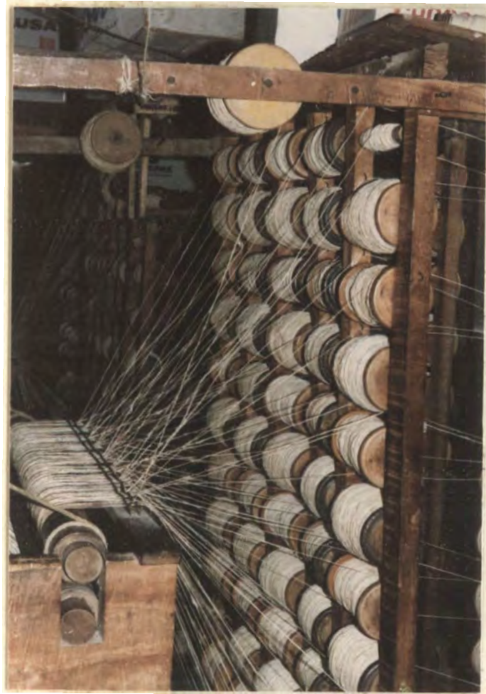
Fotografía 26. Mesa vertical surtida con los carretes del hilo montado al telar. Guarne
