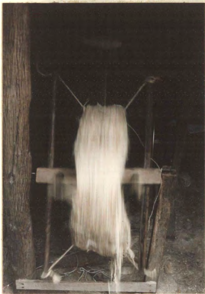
Fotografía 19. Madejero en función sur- tiendo un carrete de trama. Guarne.
