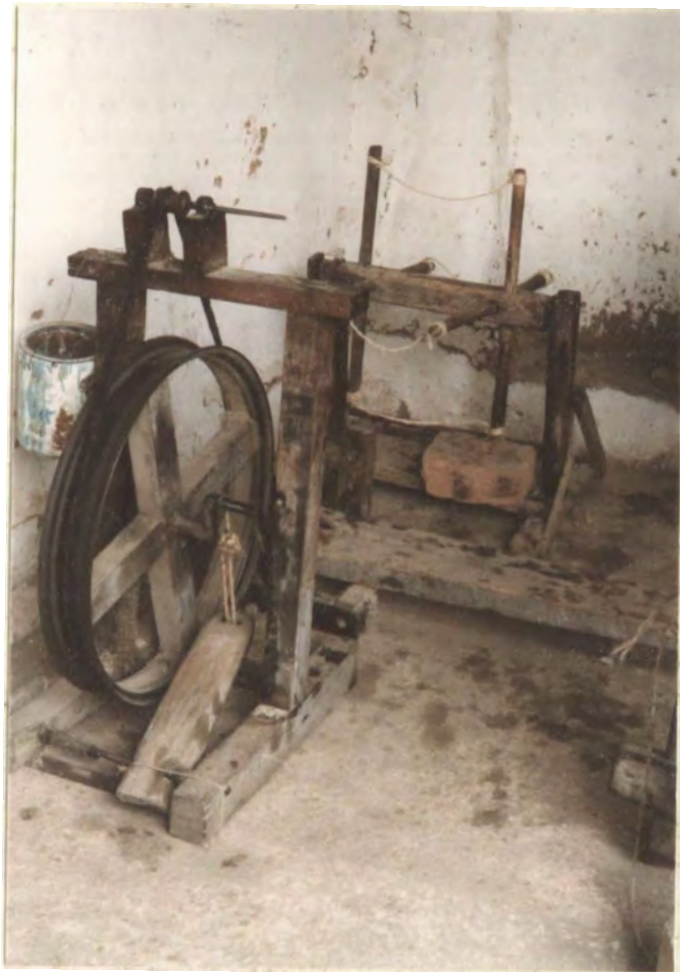
Fotografía 15. Madejero y Torno de pedal para surtir los carretes de urdimbre y de trama. Guarne.
