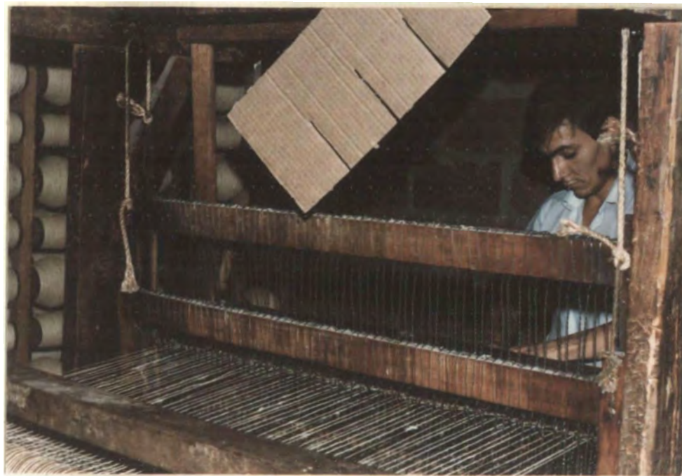
Fotografía 30. Pasados por las mallas de los marcos, los hilos se pa- san por el peine. Guarne.
