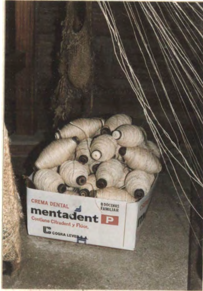
Fotografía 22. Carretes de trama surtidos y listos para montar en la lanzadera. Guarne.
