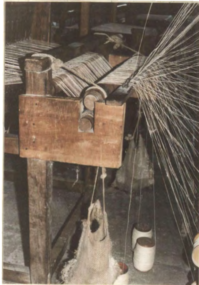
Fotografía 27. Recorrido de los hilos de la urdimbre en el telar, de atrás hacia adelante. Guarne.
