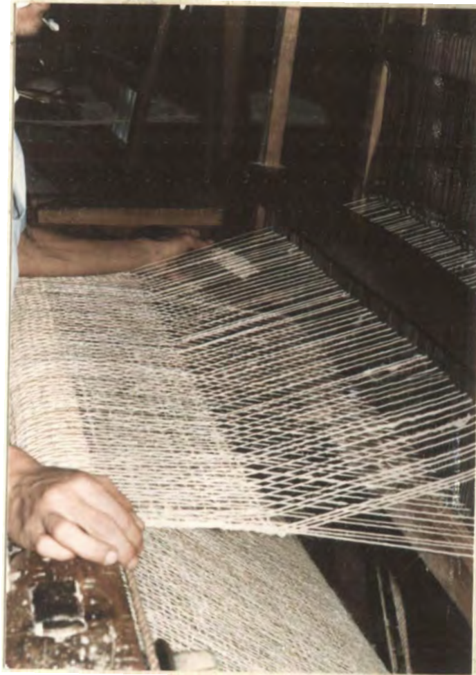
Fotografía 32. Pasado de la lanzadera con la trama por entre la calada. Guarne
