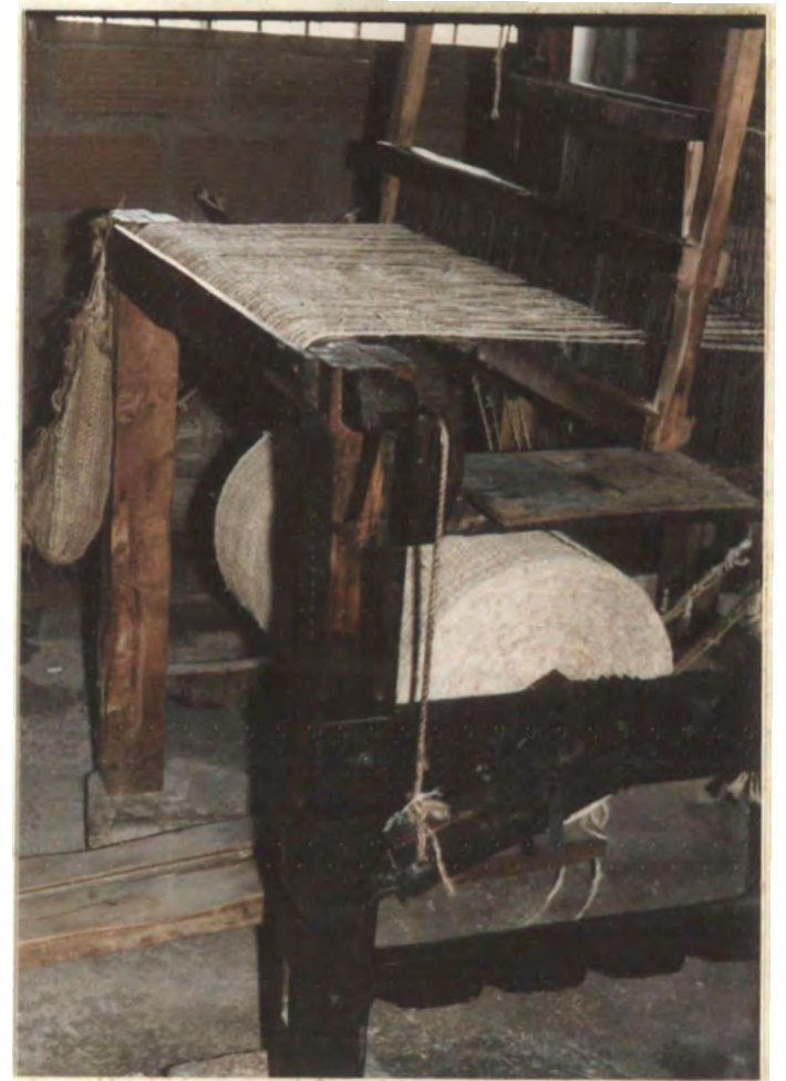
Fotografía 28. Urdimbre montada y tejido ya iniciado. Guarne.
