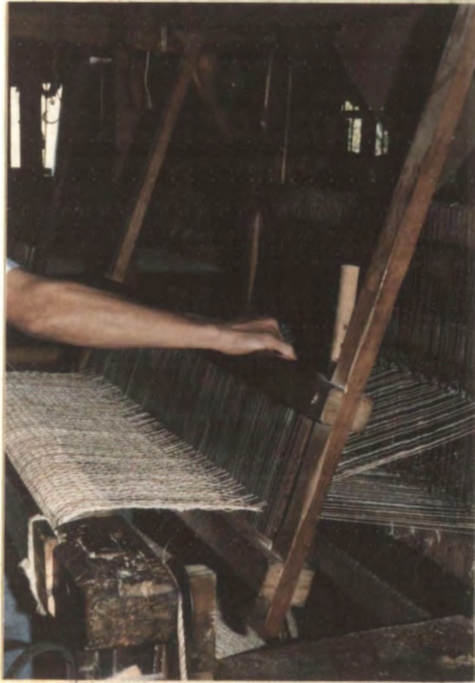
Fotografía 36. El peine se acciona de atrás hacia adelante sobre la pasada de trama. Guarne.
