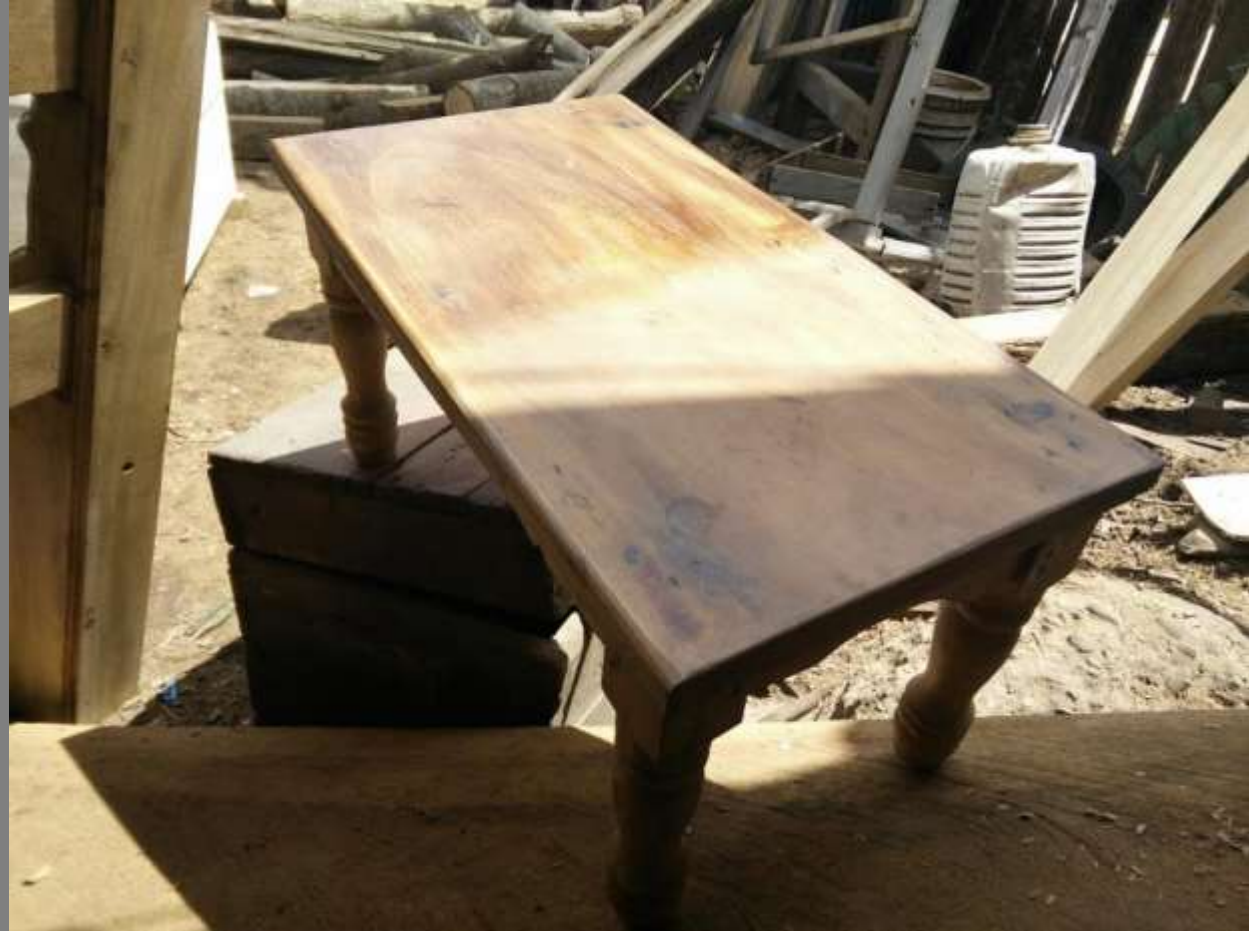
FOTO TOMADA POR: CARLOS RAMOS TALLER DE ACABADOS, MOMPOX, BOLIVAR. PARA REALIZAR EL PROCESO DE LIJA SE LE APLICO ANTES DE CADA LIJADA SELLADOR LIJABLE CON EL FIN DE IR CERRANDO LOS PORROS Y RAYAS EN LA MADERA PARA LOGRAR UN ACABADO MAS UNIFORME EN LA SUPERFICIE
