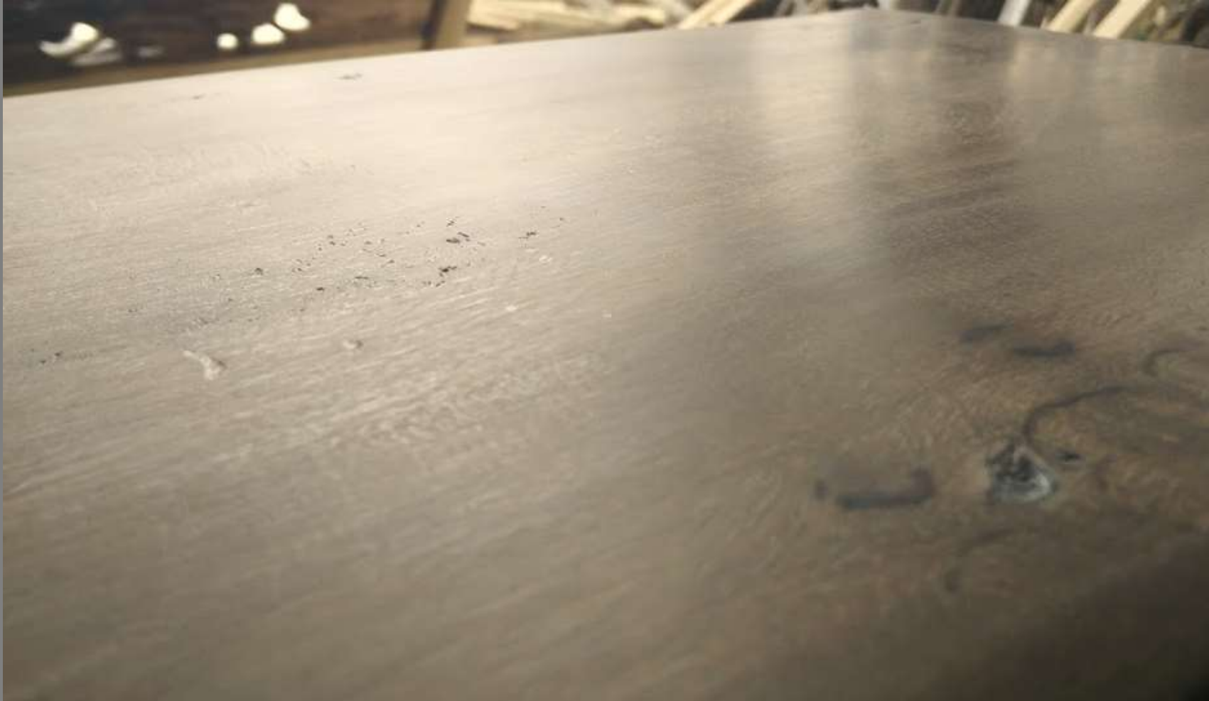
FOTO TOMADA POR: CARLOS RAMOS TALLER DE ACABADOS, MOMPOX, BOLIVAR LADO IZQUIERDO DE LA SUPERFICIE SIN LIJAR, LADO DERECHO DE LA SUPERFICIE LIJADO
