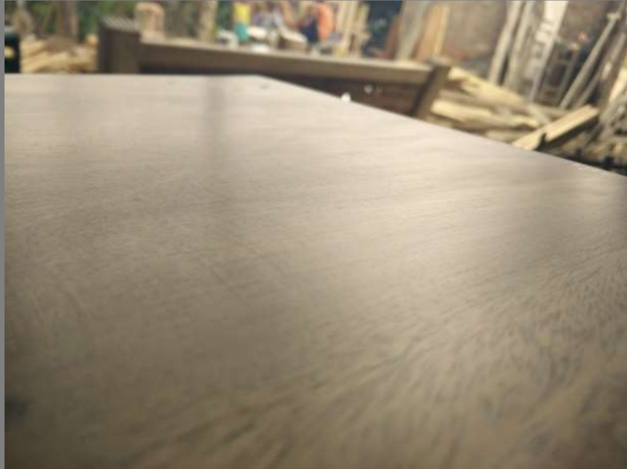
FOTO TOMADA POR: CARLOS RAMOS TALLER DE ACABADOS, MOMPOX, BOLIVAR DESPUES DEL PROCESO DE LIJADO
