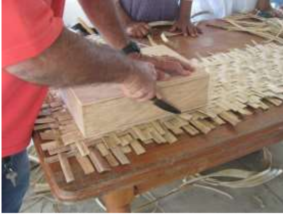
Corte del tejido utilizando el molde Fotos María Elena Uribe Vélez Artesanías de Colombia S.A
