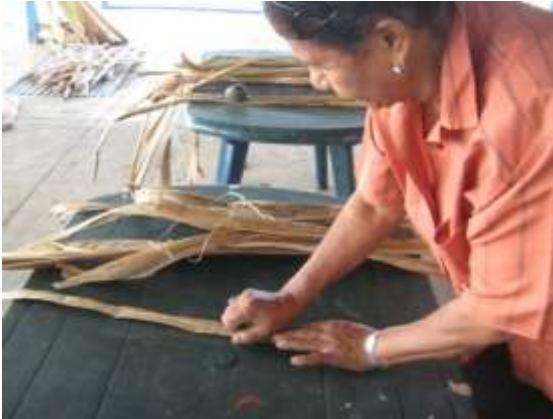
Laminado o aplanado de la calceta y corte de cintas para iniciar el tejido plano Fotos María Elena Uribe Vélez Artesanías de Colombia S.A.
