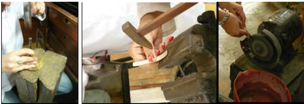
Textura con cincel plano Textura con culata de martillo Elaboración cinceles para texturas Marmato 2015. Fotos Jairo Barbosa Neira
