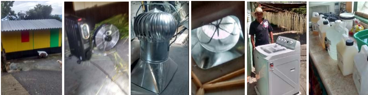
Equipos: Caseta eficiente de secado de Iraca con extractor eólico, recirculación de aire caliente y frío, natural y artificial, con control de temperatura manual y automático, equipo de lavado - centrifugado y auxiliares textiles. Aguadas2015
