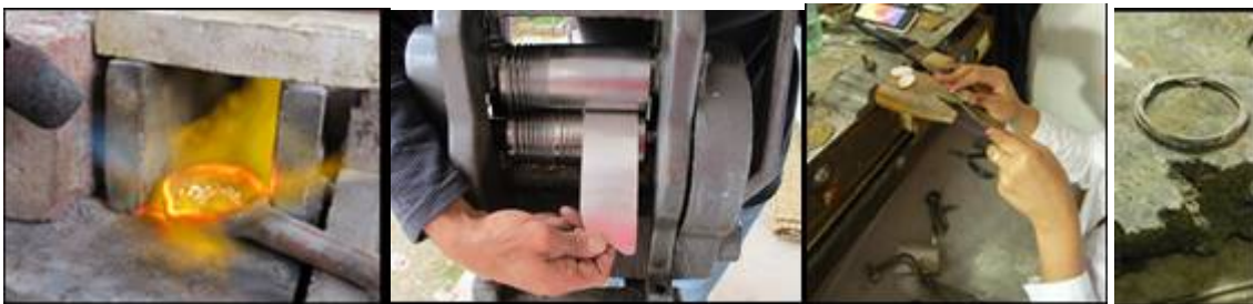
Diseño, texturado, laminado, fundición y recido de material, preparación de hilo. Marmato 2015 Fotos Jairo Barbosa Neira
