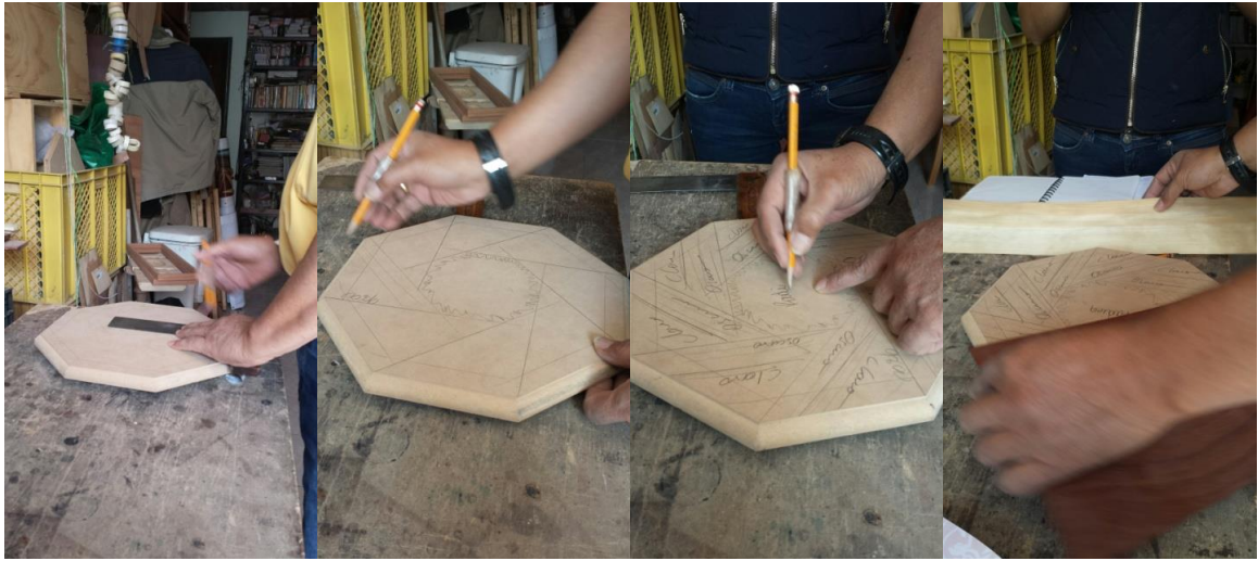
Proceso del trazado de diseño sobre la pieza, para posteriormente enchapar. Lugar: taller. 23/09/2014. Fotografía: Gabriela Oliva-Victoria Rodríguez. Artesanías de Colombia.
