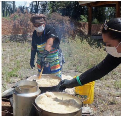
Toma de temperatura del baño de descruce, usando el termómetro
