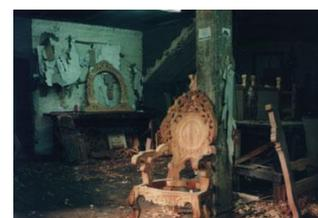
Cuenta con un área de 64 mts<sup>2</sup> aproximadamente. Esta dividida por una pared en dos partes significativas; en una se hacen labores de corte, tallado, ensamble etc. y en la otra se seca y se pinta y se almacena. La iluminación es de tipo incandescente y es muy insuficiente. La ventilación también es insuficiente. Los trabajadores no cuentan con elementos de seguridad industrial.
