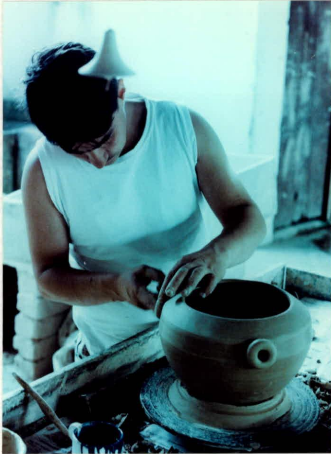
COLOCACION ASAS A LA MATERA
