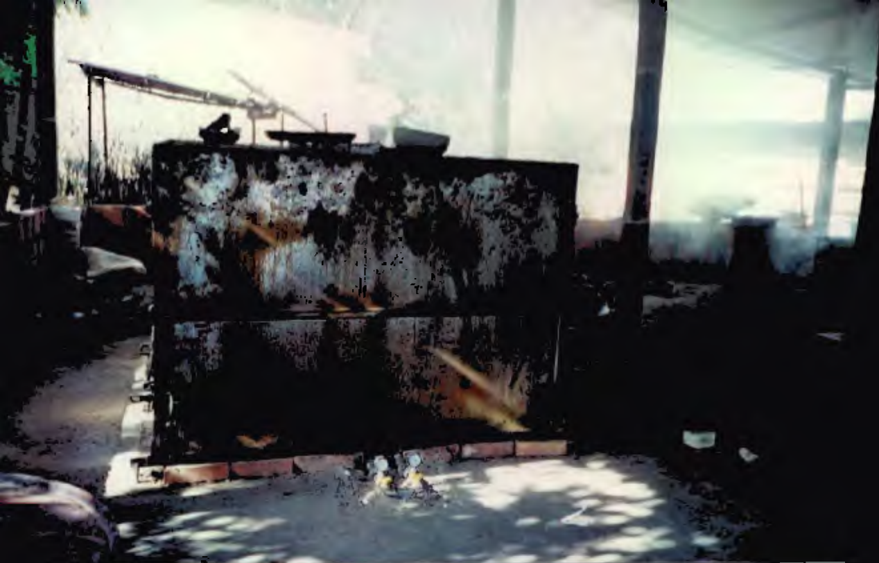
Proceso de quemá y negreado Horno Taller Betancourt 04-37-319 La Chamba No. 97
