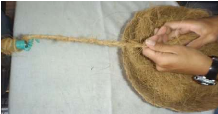
Ilustración 13: Hilado mediante motor de baja velocidad
