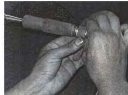
Pulimento con dedo de felpa prensada
